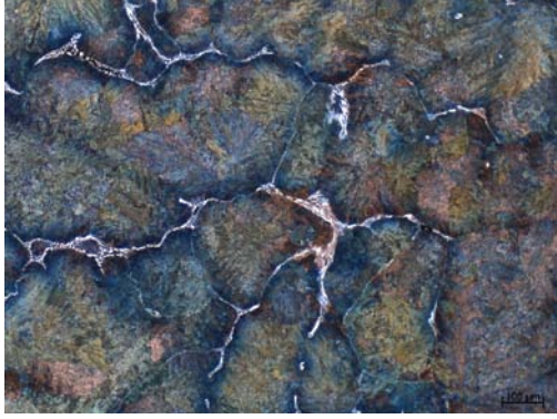
图 2 连铸坯网状碳化物
