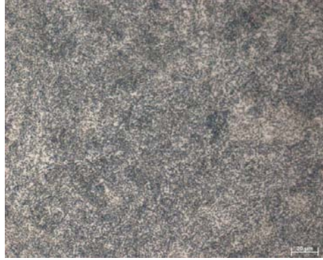
图 3 热挤压后网状碳化物破碎
