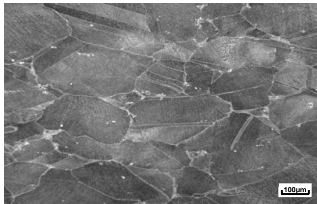
a) 棒材中析出大量 \text{Ni}_3\text{Nb} 相
